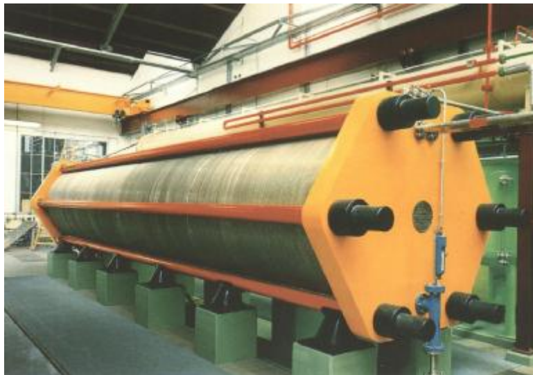
Bild 1 Druckelektrolyseur (System Lurgi) zur Erzeugung von 760 \text{ m}^3/\text{h} \text{H}_2
