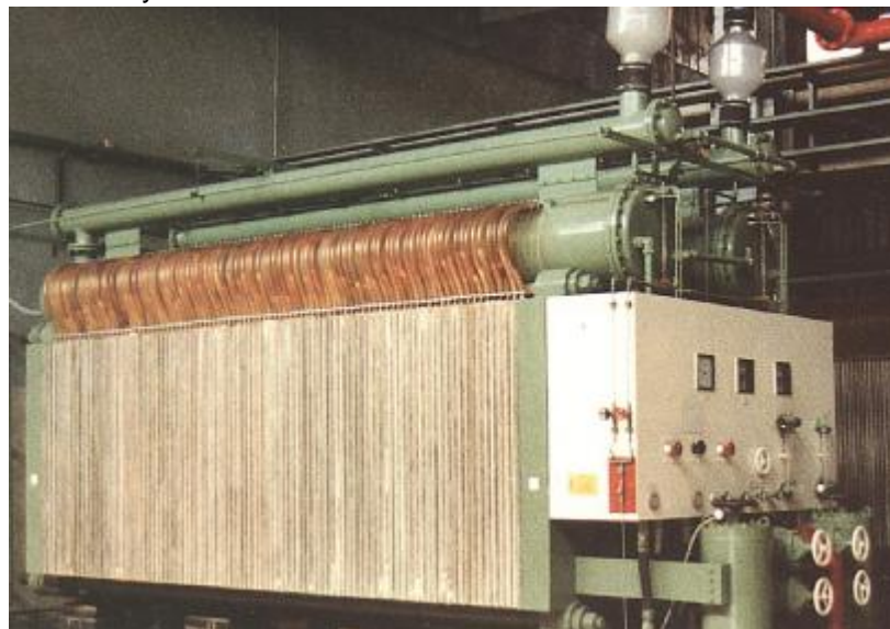
Bild 3 Atmosphärischer Elektrolyseur (System BAMAG) zur Herstellung von 300 Nm 3 /h H 2
